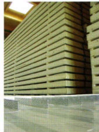
Bild 6 Die mit den eingeklebten Schubverbindungsblechen versehenen Deckenunterteile, bereit für die Verlegung
