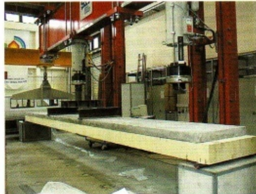
Bild 5: Der rund 10 m lange Holz-Beton-Verbundträger in der Presse, die Messfühler sind noch nicht befestigt.
