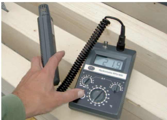
Abb. 9: Messung der Lufttemperatur während des Einklebevor- gangs
