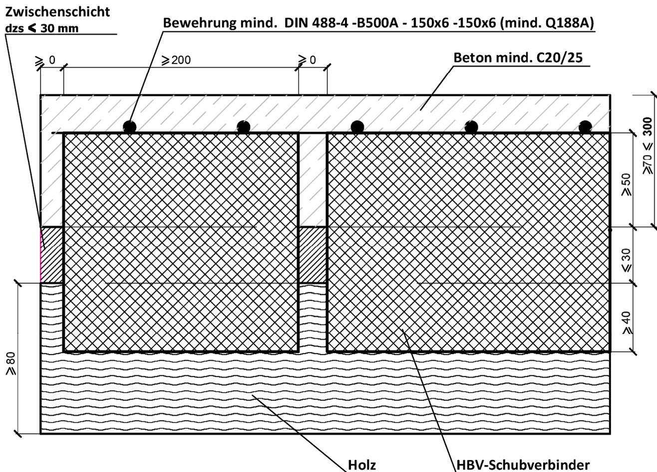
HBV-Schubverbinder aus Streckmetall und vorgefertigte Bauteile mit eingeklebten HBV-Schubverbindern für ein Holz-Beton-Verbundsystem
